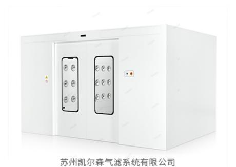
风淋室是一种通用性较强的局部净化设备,能有效的阻断或减少尘源进入洁净区。风淋室通常应用于微电子车间、光电行业、半导体行业、医药生产、食品加工、航空航天、汽车行业、印刷行业、生物实验室等各个无尘车间与非无尘车间、阶梯洁净度车间中。用于从低洁净度房间进入高洁净度房间过程中,净化除去人员各部位大于0.3微米粉尘颗粒,以免带入污染。风淋室也同时起到气流缓冲作用:在开门的过程中,净房之间带有空气的流动,风淋室可以很好的把气流流动停于风淋室内部,避免了空气流动所带来的空气污染。上海风淋室加工风淋室的售后和维护。
